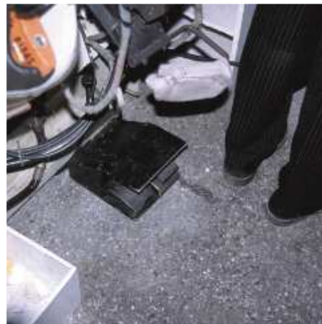
Pelindung di atas pedal kaki dari mesin yang digerakkan oleh daya listrik
