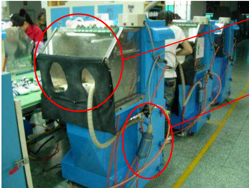
Gambar 11.10 – Pemasangan Minimisasi Debu dan Bising pada Mesin
