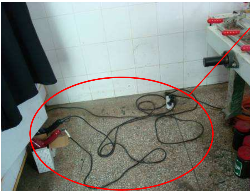
Gambar 11.12 – Penyimpanan Perkakas Genggam dan Sistem Kabel Yang Tidak Benar
