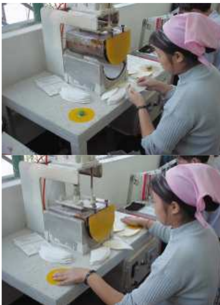
Mesin dengan saklar dua tangan (tidak berfungsi pada modus satu tangan) menggunakan tangan pelindung : proses pemotongan
