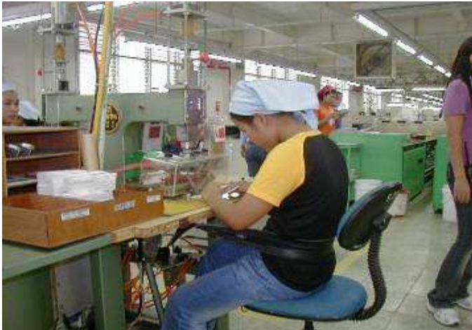
Gambar 21.1 – Posisi Kerja Yang Buruk
