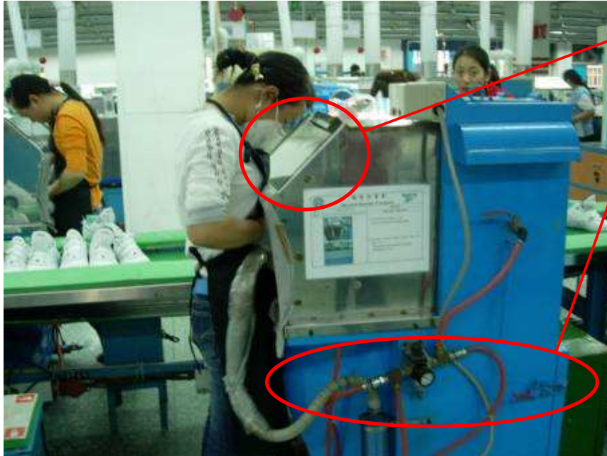
Gambar 11.8 – Pemasangan Pelindung Dari Debu dan Bising pada Mesin
