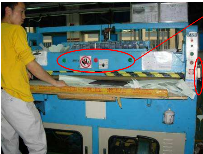
Gambar 11.9 – Saklar Tangan dan Divais Inframerah Yang Dipasang Untuk Meningkatkan Keamanan Operasi Mesin
