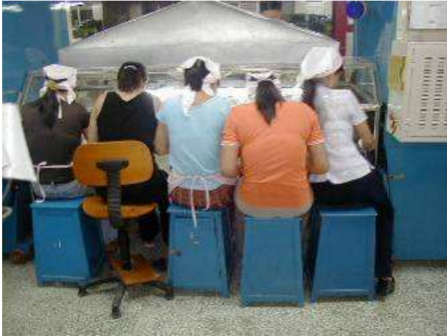
Gambar 21.6 – Tempat duduk yang dibatasi mengakibatkan stress terpusat akibat tertekan dan terbentur
