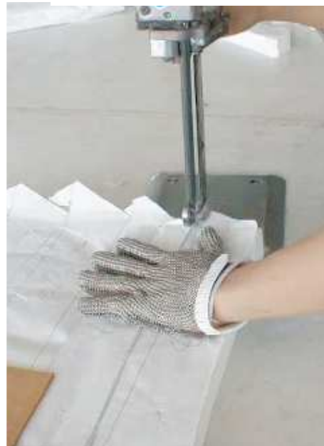
Mesin dengan saklar dua tangan (tidak berfungsi pada modus satu tangan) menggunakan tangan pelindung : proses pemotongan
