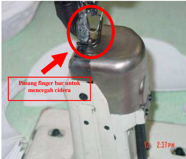
Gambar 11.6 – Pemasangan Needle Guard pada Mesin Penjahit
