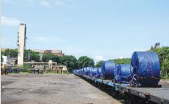
Muatan baja coil diangkut dengan gerbong datar PPCW. http://kereta-api.co.id
