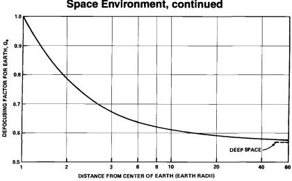
DEFOCUSING FACTOR DUE TO EARTH'S GRAVITY FOR AVERAGE METEOROID VELOCITY OF 20 km/s
