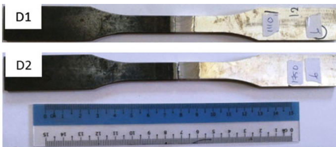
Fig. 5 Tensile specimens D1 and D2 for dissimilar material FSW
