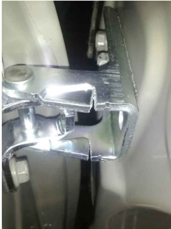
Fig. 6 Broken door hinge on actual test
