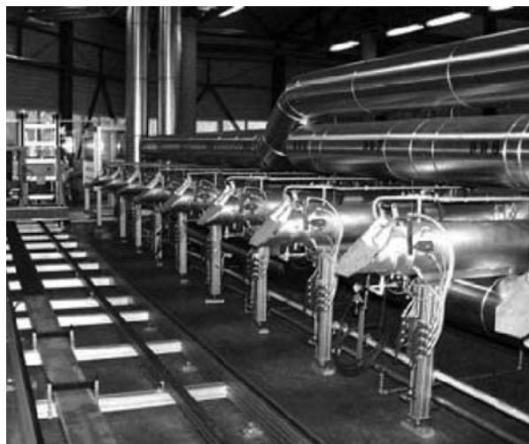
Figure 21.16 Single tube push type furnace for tungsten carbide powder production. Courtesy: Wolfram Bergbau- und Hütten-GmbH.
